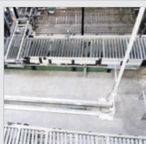
un transstockeur conventionnel avec longues zones tampon, avec place morte.
